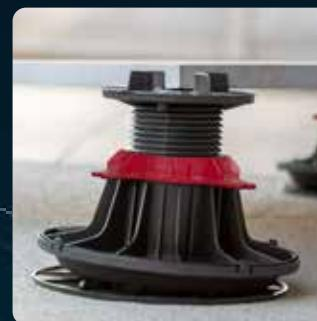
Le disque autonivelant est utilisé pour rattraper jusqu'à 5% de pente sur 1 mètre. Ainsi, il permet l'installation d'une structure sur un sol non nivelé. Cet accessoire est compatible avec tous les plots de la gamme bois et dalle à partir du 40/60 mm.
