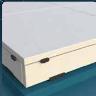
Le support d'habillage se fixe à la base du plot par emboîtement permettant ainsi la pose verticale d'une dalle ou d'une lame en bois pour l'habillage de la contre-marche de la structure. Utilisé avec une plaque à dalle il permet de réaliser la fermeture latérale pour une finition parfaite.
