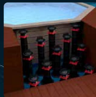
Les rehausse permettent d'augmenter la hauteur finale du plot. Il est possible d'empiler jusqu'à 4 rehausse sur 1 même plot pour obtenir 440 mm de hauteur supplémentaire. Compatible avec les plots de la gamme bois et dalle à partir du 60/90 mm pour la rehausse de 60 mm et à partir du 90/150 mm pour la réhausse de 110 mm. Les rehausse permettent d'atteindre une hauteur finale de 70 cm.
