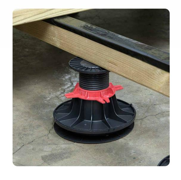
A noter : toujours calculer la hauteur à rattraper en déduisant l'épaisseur de la lambourde et du revêtement afin d'obtenir la taille de plot nécessaire.
