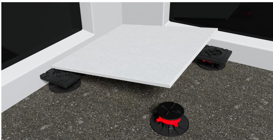
Placer les dalles sur la périphérie et contrôler l'équerrage de la pose afin de faciliter la pose des autres dalles.
