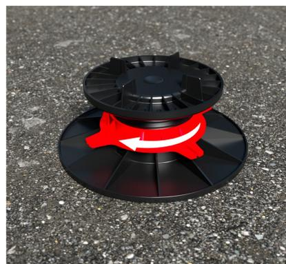
**Astuce:** Si votre sol est en pente, utiliser un disque autonivelant qui peut rattraper jusqu'à 5% de pente sur 1 mètre. Cet accessoire est utilisable à partir de la dimension 40/60 mm.
