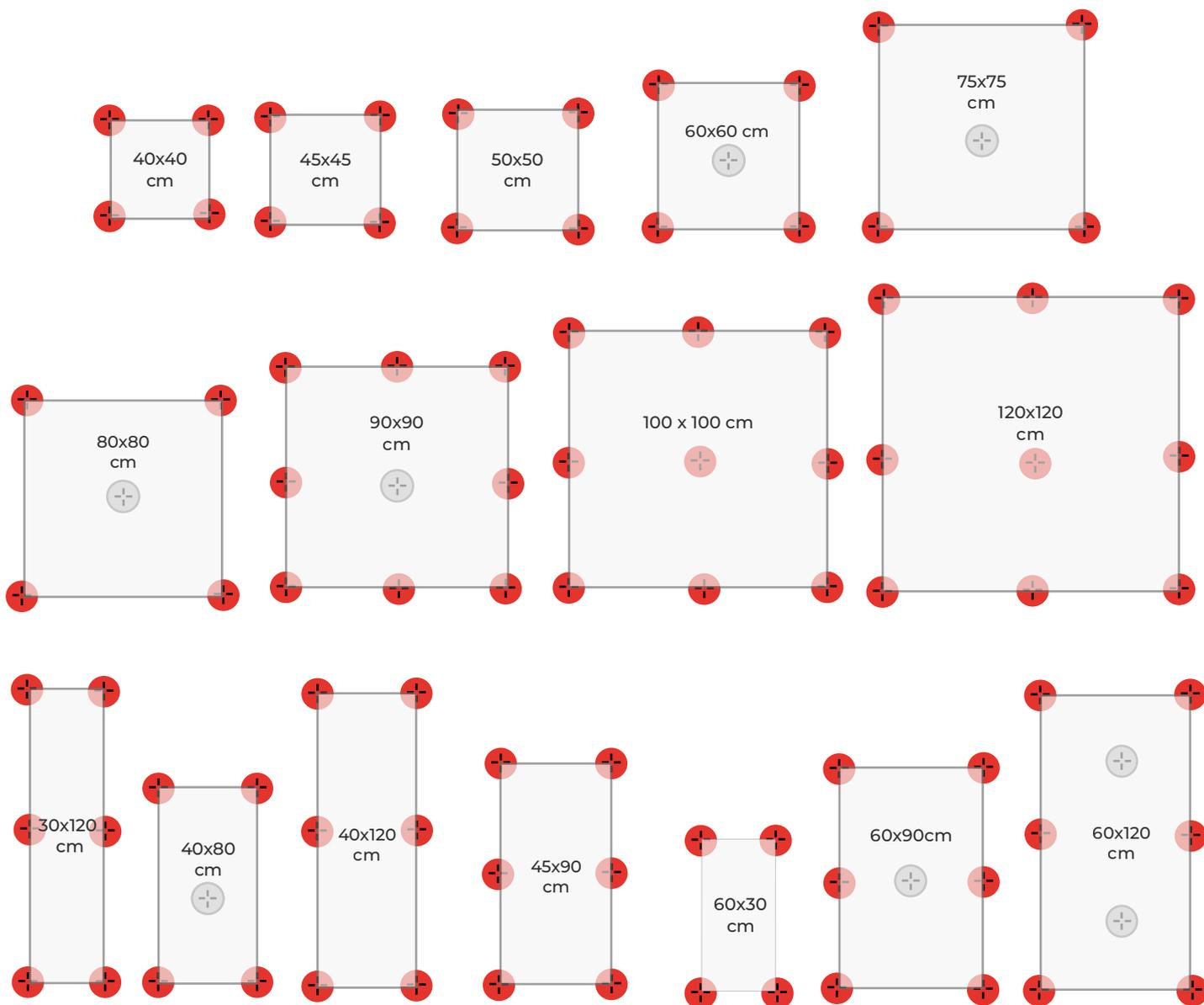
La quantité de plots nécessaire dépend de la dimension des dalles utilisées. D'une manière générale, il faut 1 plot par angle soit 4 plots par dalle. Il est possible d'ajouter un 5ème plot au centre de la dalle de manière à renforcer la structure ou dans le cas de dalles de grandes dimensions. Pour ce faire, casser les ailettes situées sur la tête du plot.
